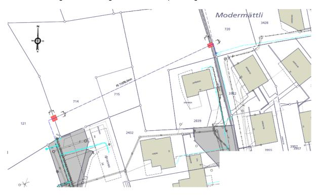
Insgesamt werden zirka 85 Meter Wasserleitung in PE110/90 (Gerofit mit Schutzmantel) neu gebaut.
